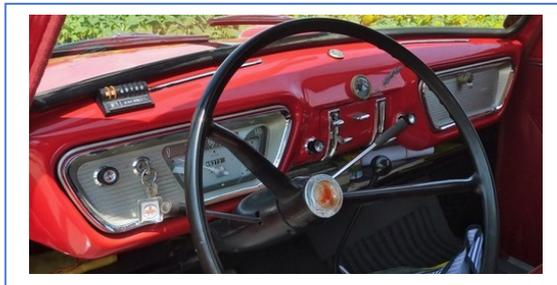
Remarquez la parfaite symétrie entre les deux logements (instruments et boîte à gants) ce qui permettait d'utiliser la même planche de bord
