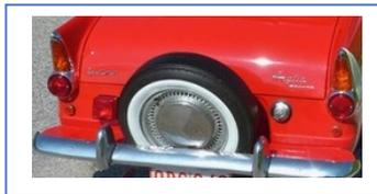
La roue de secours est installée à l'extérieur, logée sur le pare-choc arrière.
